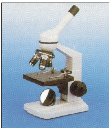
Spieghietto del microscopio (concavo)
